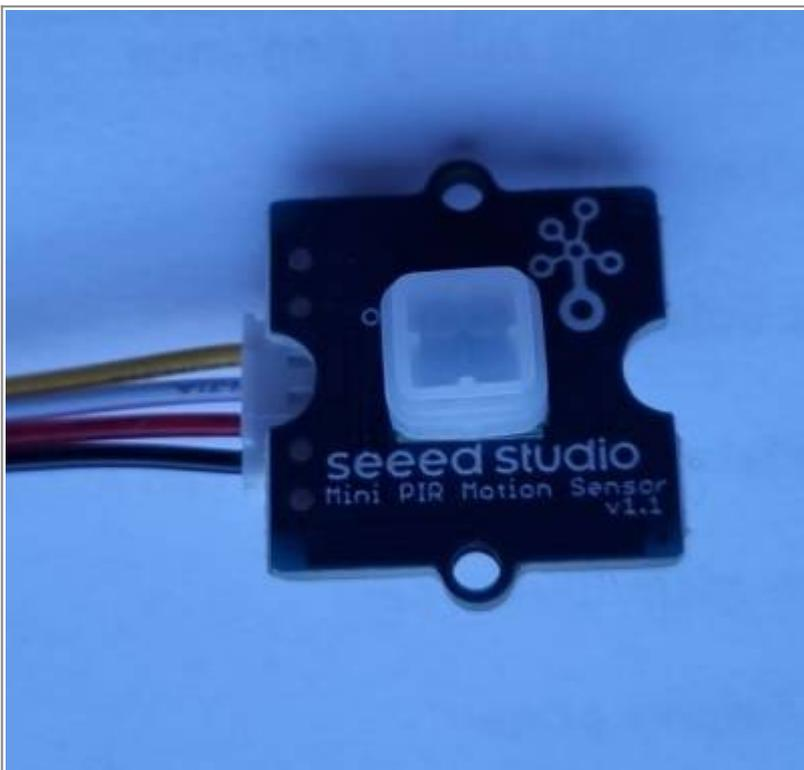
**Figure 4.** Seed Studio mini PIR motion sensor
