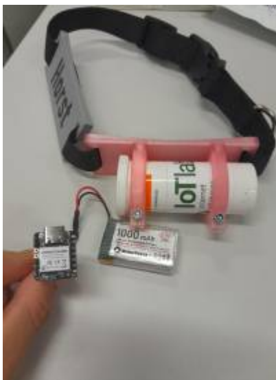
Fig. 3: Collar containing a Xiao BLE Sense module
