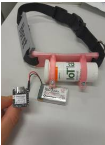
Fig. 3: Collar containing a Xiao BLE Sense module
