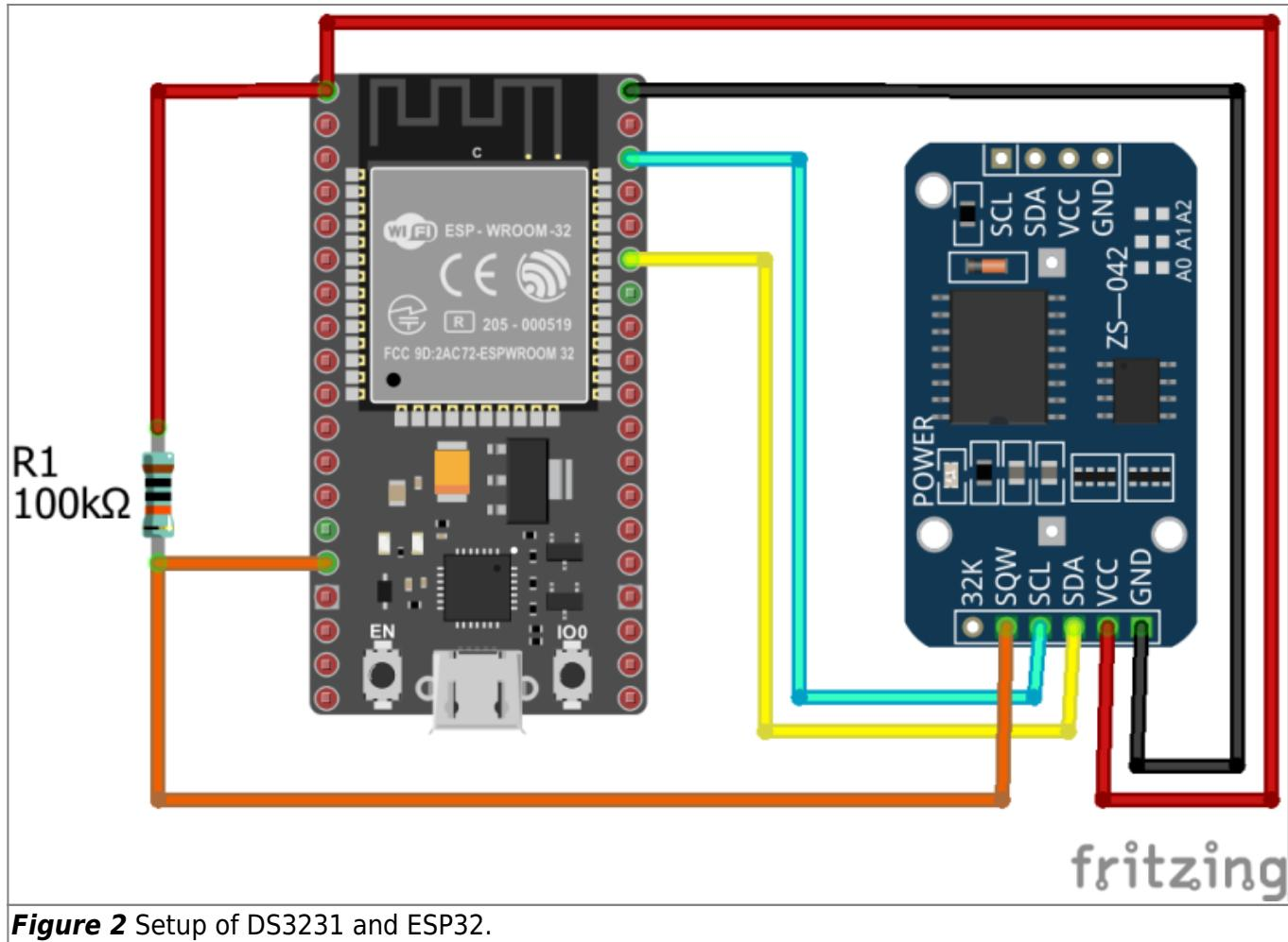
**Figure 2** Setup of DS3231 and ESP32.
