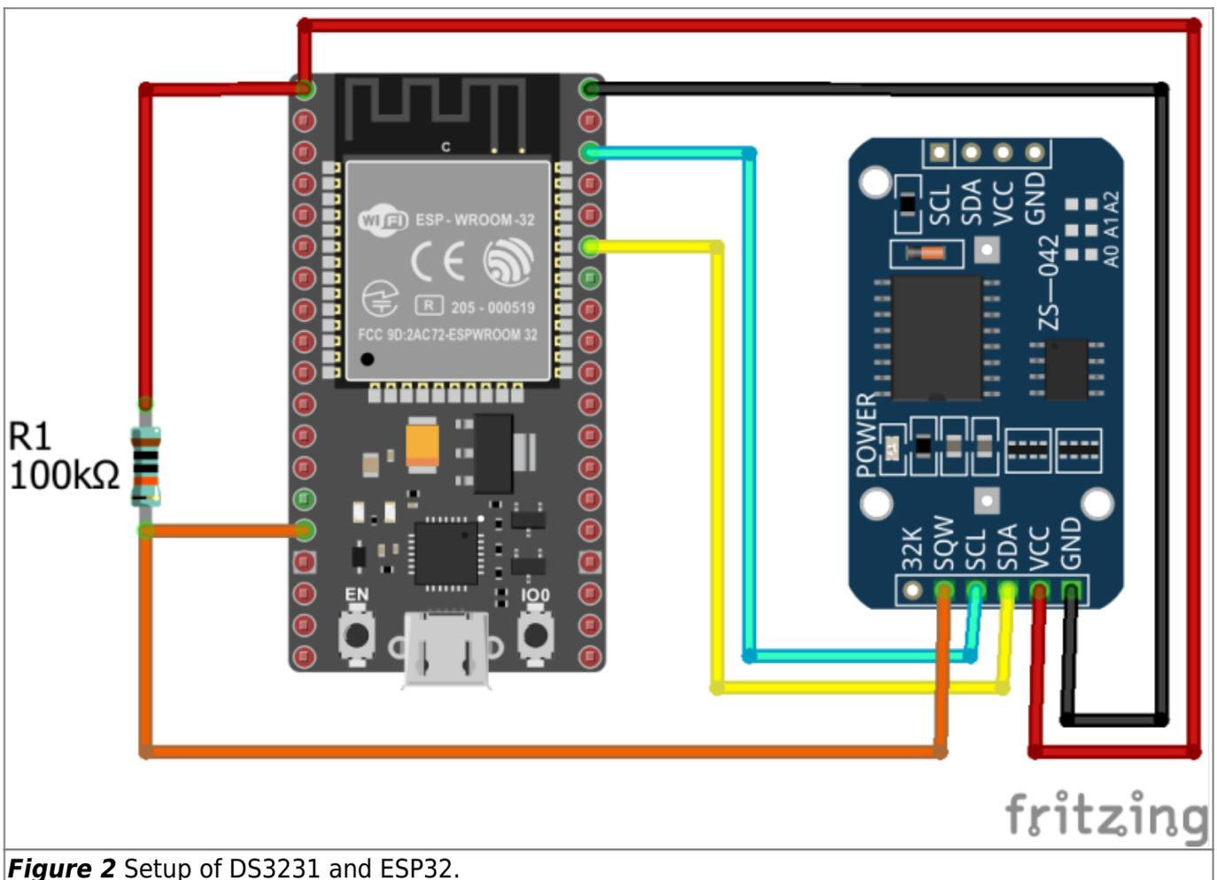
**Figure 2** Setup of DS3231 and ESP32.
