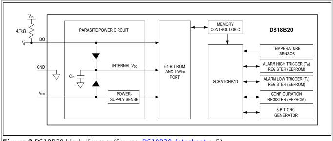
Figure 2 DS18B20 block diagram (Source: DS18B20 datasheet p. 5)
