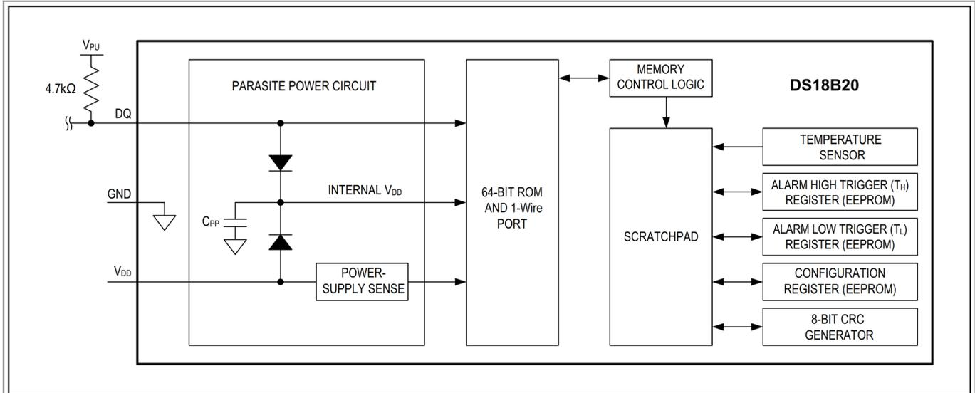
**Figure 2** DS18B20 block diagram (Source: [DS18B20 datasheet](#) p. 5)
