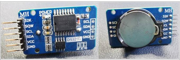
Figure 1 DS3231 RTC module
