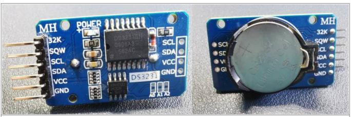
Figure 1 DS3231 RTC module
