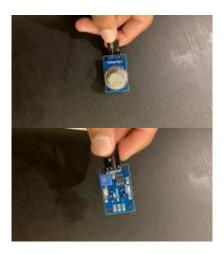
Figure 3: MQ135 Air Quality Sensor. Source: AZ-Delivery Vertriebs GmbH, Bräugasse 9, 94469, Deggendorf, Deutschland
