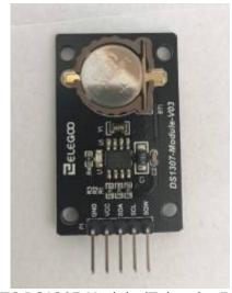
Fig. 4: RTC DS1307 Module (Taken by Emilie Streichsbier
