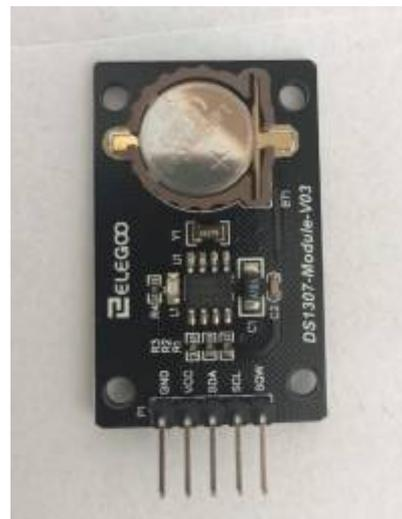
Fig. 1: RTC DS1307 Module (Taken by Emilie Streichsbier)
