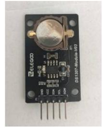
Fig. 4: RTC DS1307 Module (Taken by Emilie Streichsbier
