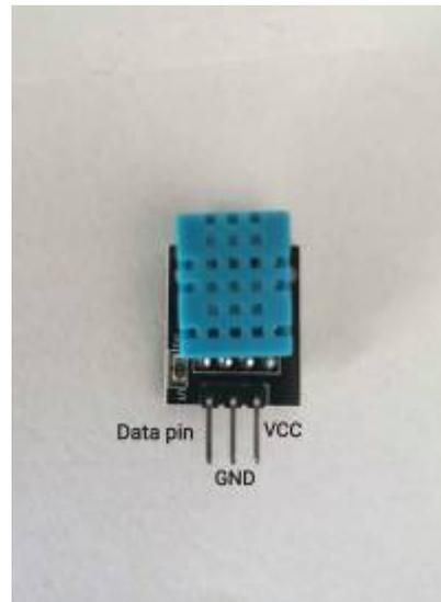
Fig. 2: DHT11 Sensor Module (Taken by Emilie Streichsbier)
