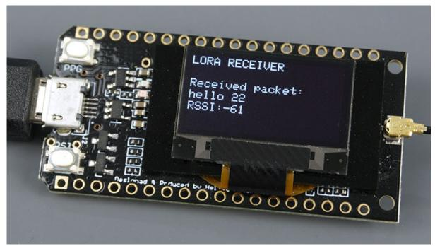
Fig.: TTGO LoRa32 OLED V1.
