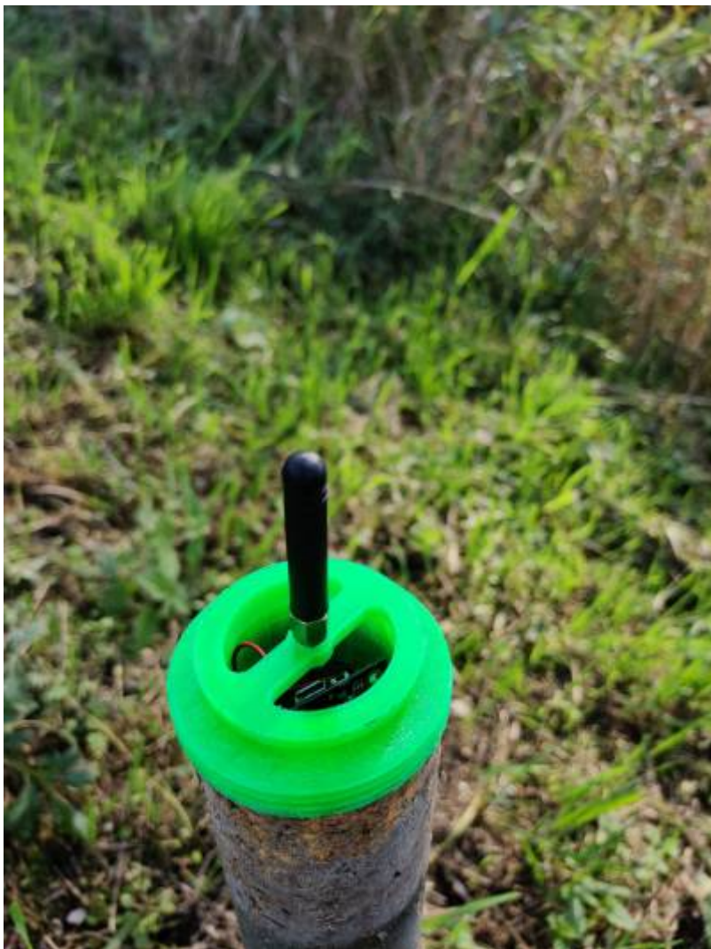
Fig. 8: Sensor und LoRa-Sender im Rohr installiert
