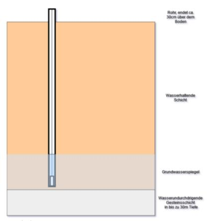
Fig. 1: Grundwasser-Pegelrohr
