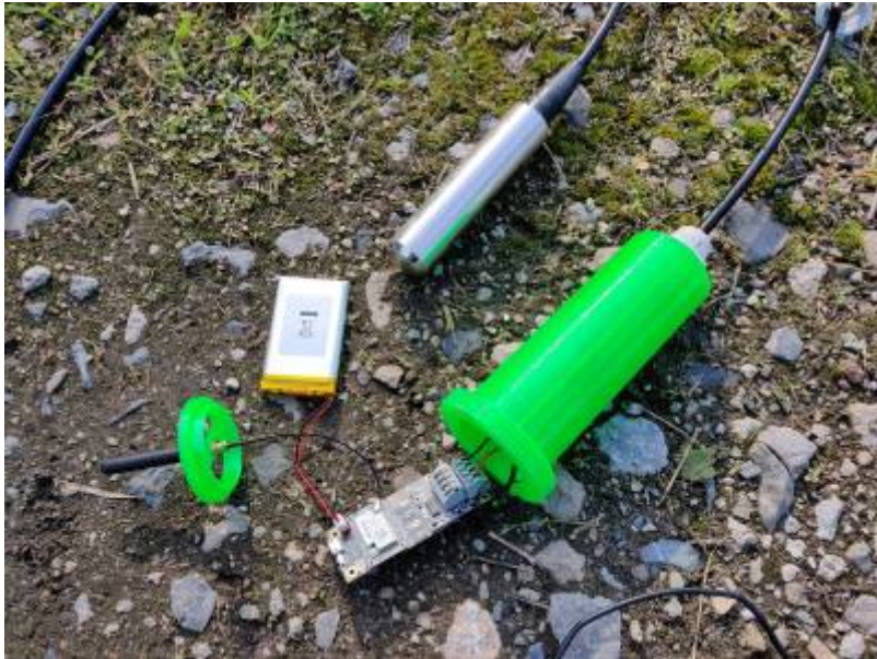
Fig. 8: Rak 4630 Board mit Batterie
