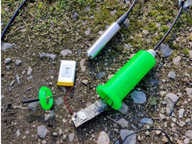
Fig. 8: Rak 4630 Board mit Batterie
