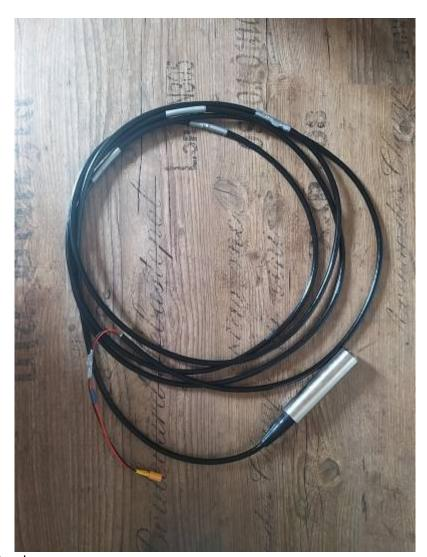
Fig. 4: Prototyp 1-Sonde
