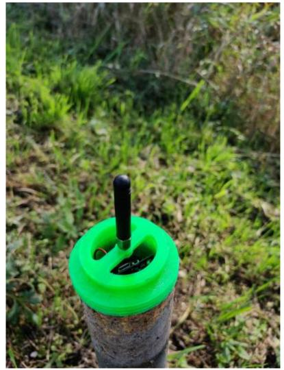
Fig. 8: Sensor und LoRa-Sender im Rohr installiert
