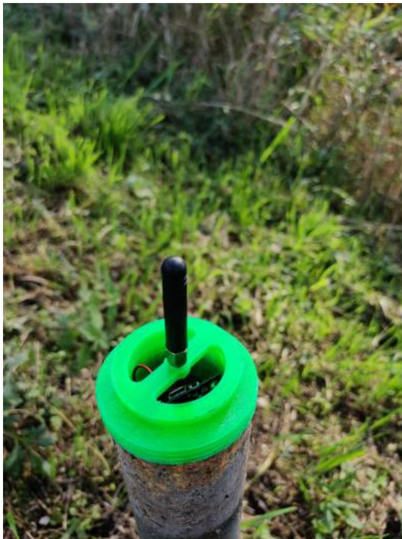
Fig. 8: Sensor und LoRa-Sender im Rohr installiert
