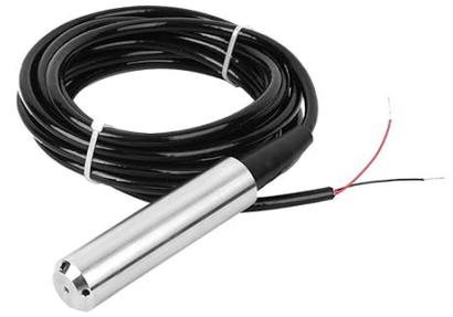
Diese Art von Sensoren wird meist über die Stromschnittstelle "4 .. 20mA" betrieben. Dabei muss die Node den Strom messen, welcher der Sensor verbraucht. Dieser liegt dann zwischen 4mA und 20mA. Der Messbereich des Sensors muss dann auf den Bereich 4mA bis 20mA übertragen werden. Ist der Messbereich des Sensors bspw. mit 0m bis 100m angegeben, würde bei einer 0m Messung 4mA an Strom fließen und bei 100m 20mA.
