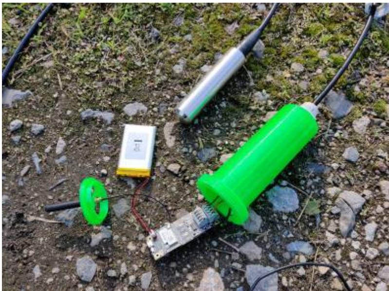
Fig. 8: Rak 4630 Board mit Batterie
