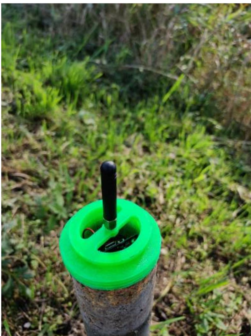
Fig. 8: Sensor und LoRa-Sender im Rohr installiert
