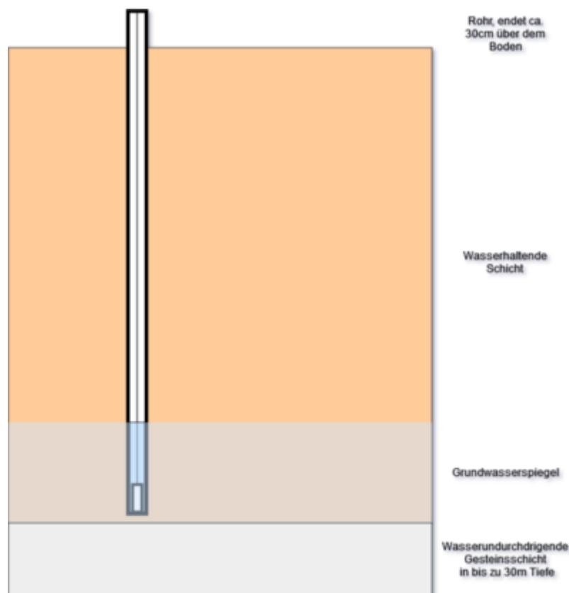
Fig. 1: Grundwasser-Pegelrohr
