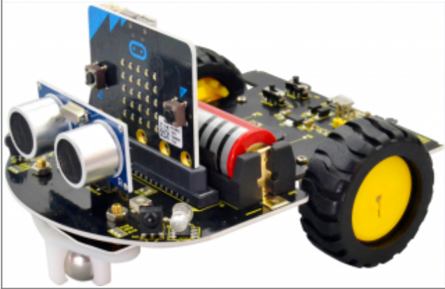
5. Micro:bit Robot Car Keyestudio Micro:bit Mini Smart Robot Car
