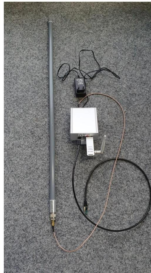
Lite Gateway inklusive WLAN Adapter, Antenne und Spannungsversorgung
